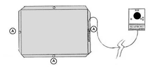
A RECOMMENDED REMOTE T-STAT PROBE POSITIONS
